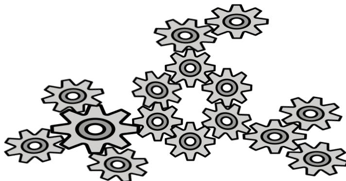
**Решение.** Если шестерёночный механизм движется, то две соприкасающиеся шестеренки обязательно движутся в противоположном направлении. При движении шестерёночного механизма любая фиксированная шестерёнка вращается либо по часовой, либо против часовой стрелки. Вращение любой фиксированной шестерёнки полностью определяет вращение всего механизма.
